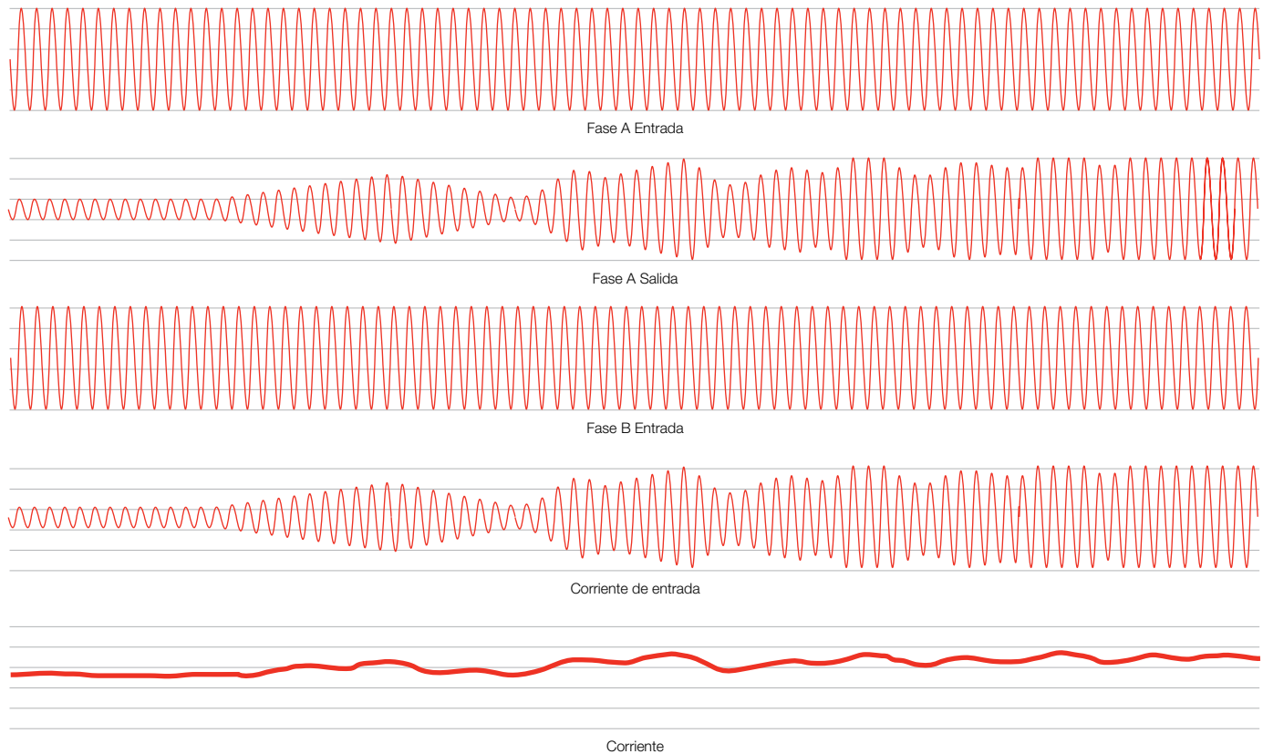
FIGURA 6b: El registro superior es un voltaje de fase A, el segundo es una corriente de fase A, el tercero es un voltaje de fase B, el cuarto es una corriente de fase B y el registro inferior es la salida del regulador de voltaje.
