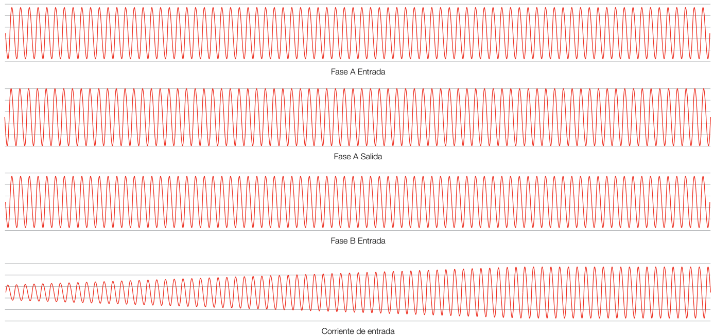
FIGURA 6a: El registro superior es un voltaje de fase A. El segundo registro es una corriente de salida de fase A de un UPS. El tercer registro es un voltaje de entrada de fase B hacia el UPS y la cuarta línea es un amperaje de entrada hacia el rectificador del UPS.
